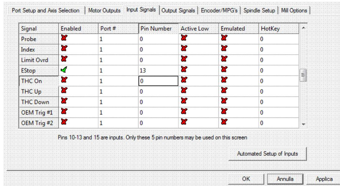
In questo caso è stato collegato il pulsante di emergenza sul contatto corrispondente al pin 13 della morsettiiera di input e di tipo NO.
